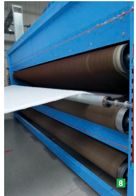
Bild 7-8: Maßgeschneidertes Trocknerband von GKD erfüllt die besonderen Anforderungen der dicken Dämmprodukte.
