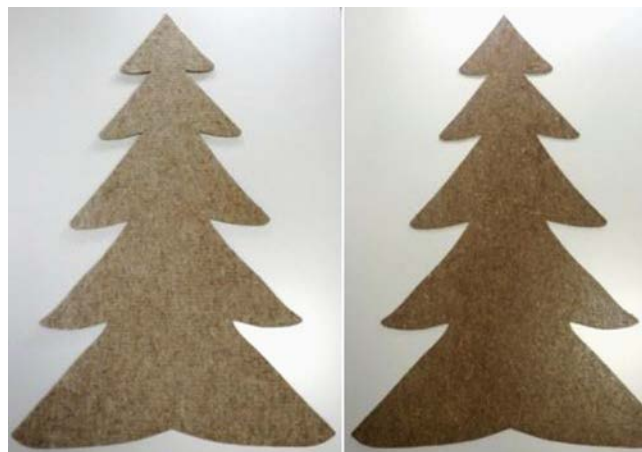
Bild 2. Zuschnitt eines NFPP-Mischvlieses vor (links) und nach (rechts) der Kompaktierung (Bild: J.H. Ziegler)
