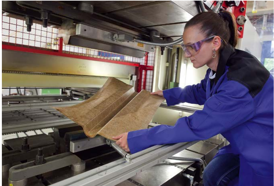
Bild 6. Industrienaher Umformversuch nach erfolgreicher Erwärmung eines NFPP-Mischvlieses im Infrarotfeld (Bild: IVW)
